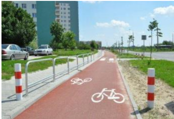
2.8 pav. Atskiro dviračių tako įrengimas su jį lydinčia infrastruktūra.
