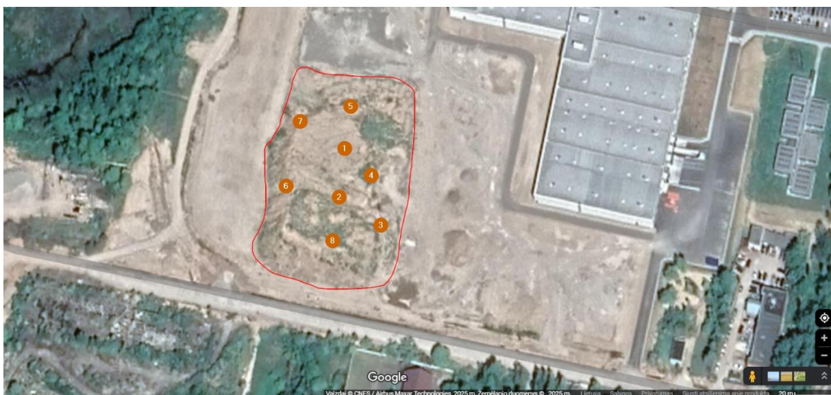
5 pav. Sandėliuojamo grunto krūva ir grunto bandinių paėmimo vietos (2025 m. sausio 21 d.)
