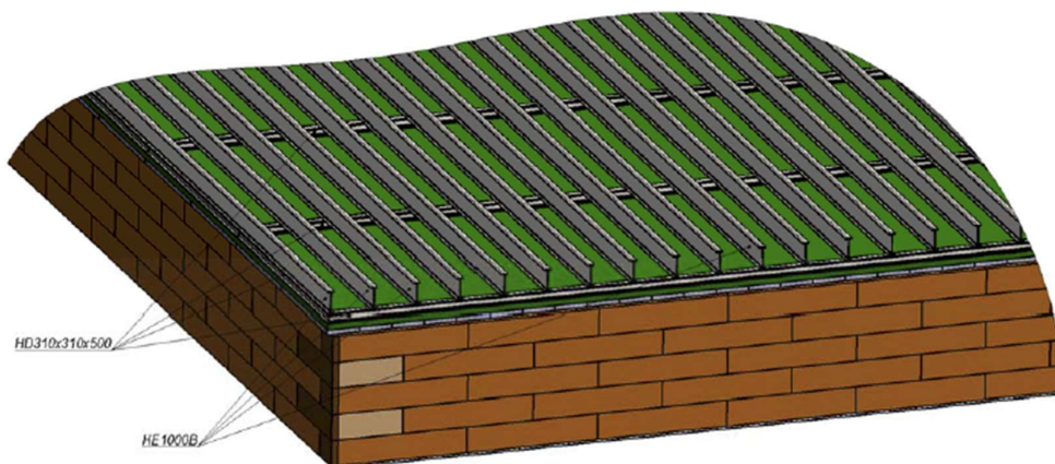
7 pav. Saugyklos inžinerinio barjero laikančiosios konstrukcijos fragmentas
