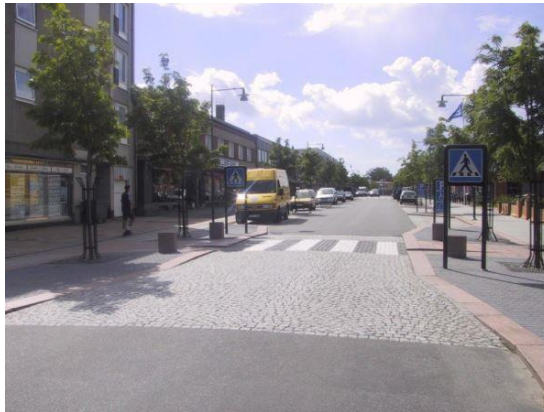
71 pav. Važiuojamosios dalies susiaurinimas.
