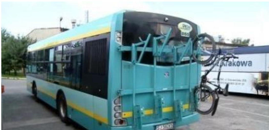
58 pav. Dviračių gabenimo sistemos keliaujant autobusais.
