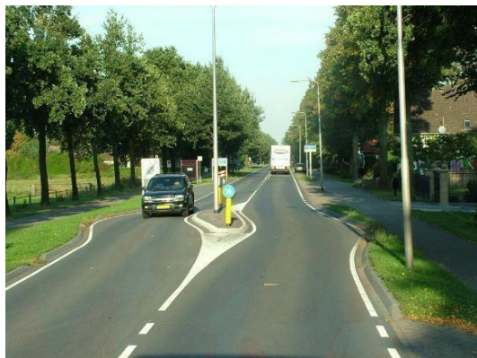
72 pav. Važiuojamosios dalies iškreivinimas.
