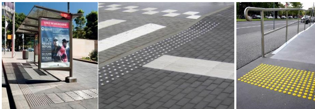
92 pav. Liečiamieji išpėjamieji (reljefiniai) paviršiai.
