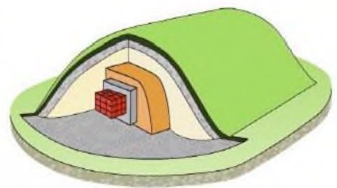
Pav. 1.7-5 Paviršinio atliekyno konceptualusis vaizdas, atliekų krovimo schema
